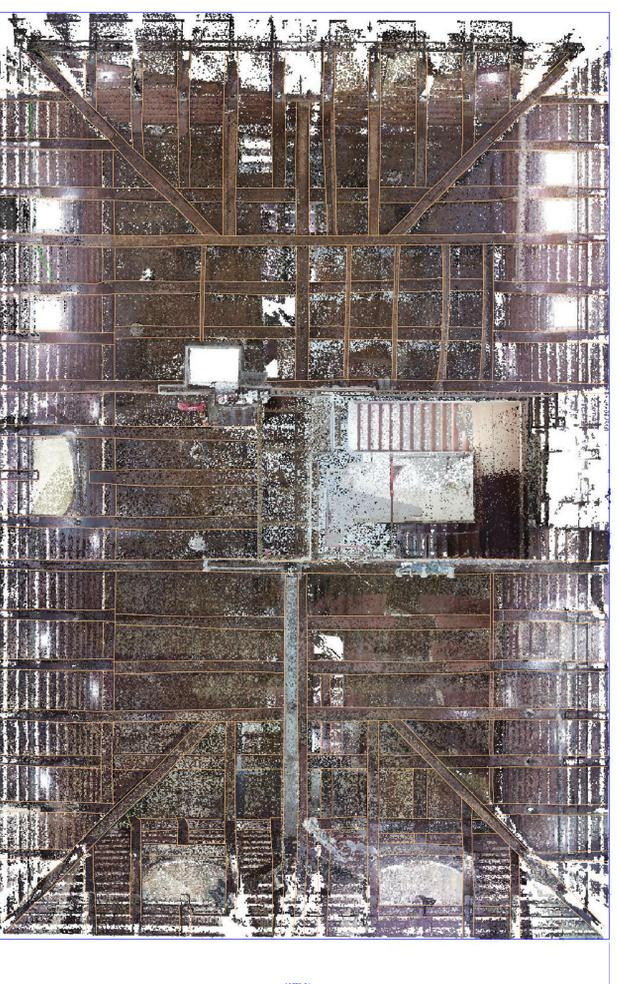
Grundriss mit Darstellung der Sparrenlage
