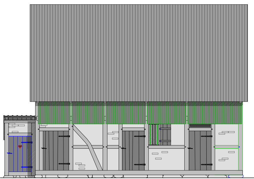
Traufseite West, Zustand 2019 (jeweils ohne Verformungen, Schäden und Notreparaturen)
